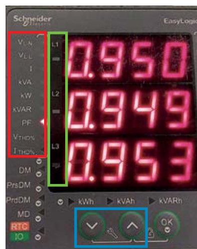
Figura 62 - Detalhes do display multimetador Schneider EasyLogic PM2100
