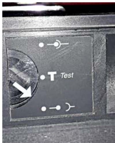
Figura 26 - Indicador de posição de destrave
